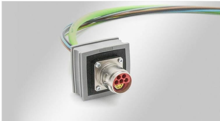
Die Adaptertülle QT-AT-B (Blindtülle) ist auf Basis einer QT Kabeltülle groß aufgebaut. Der darin integrierte Polyamidkorpus ist einseitig vollständig geschlossen. Die Nutzfläche beträgt 24 x 24 mm, die Wanddicke 6 mm. Hier können Sonderbohrungen vorgenommen oder auch kleinere Flanschbuchsen (z.B. für Hybridsteckverbinder) angebracht werden.
